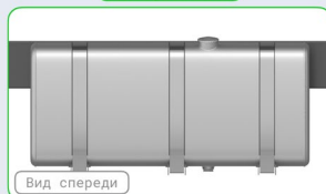
Рис. 2 — Схема установки кронштейнов на топливный бак
